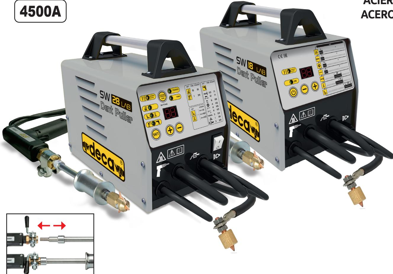
SW 18/28 avec respectivement une puissance de 3200 et 4500 A sont idéales pour la réparation des bossages et le redressement des tôles minces (capots, portières, ciels, etc.). Elles offrent différentes fonctions pour de nombreuses utilisations de la carrosserie.
